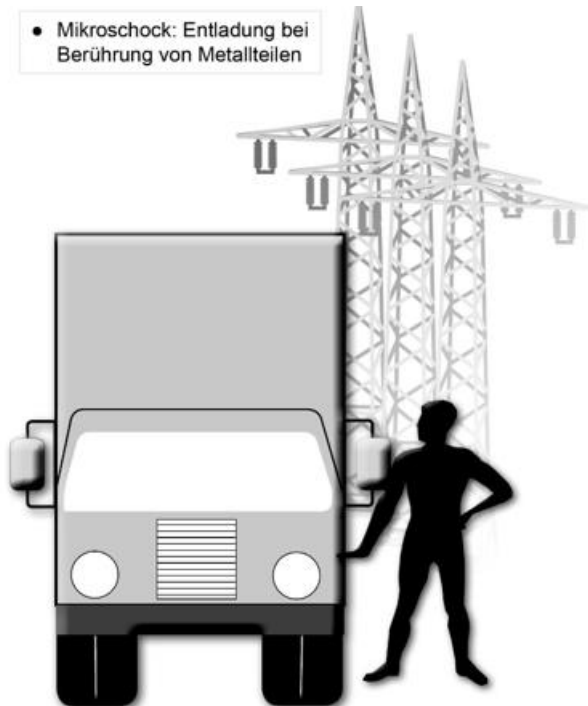
Abb. A7 Indirekte (mittelbare) Wirkung eines niederfrequenten elektrischen Feldes: Galvanische Einkopplung eines Körperstromes als mittelbare Feldwirkung
